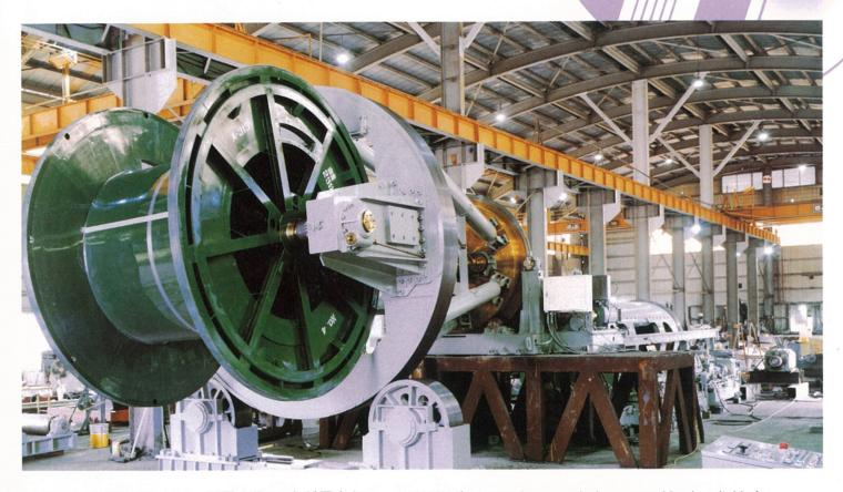
HAMANAのドラムツイスター型撚合機は、各種電力ケーブルの製造、各種被覆線の撚合せ、鉄線鎧装、通信線の燃合せに適しており、日本国内はもちろん世界各国に輸出し、多数の生産実績を誇っております。ドラムツイスターは構造上、大型化、高速化が可能であり、弊社ではこれまで巻取サイズにて \$400~\$4500mmと幅広い実績となっております。 巻取サイズにより、アンダーローラータイプ、クレードルタイプ、フォークタイプが選択でき、貴社のご要望にあわせた設計が可能です。
